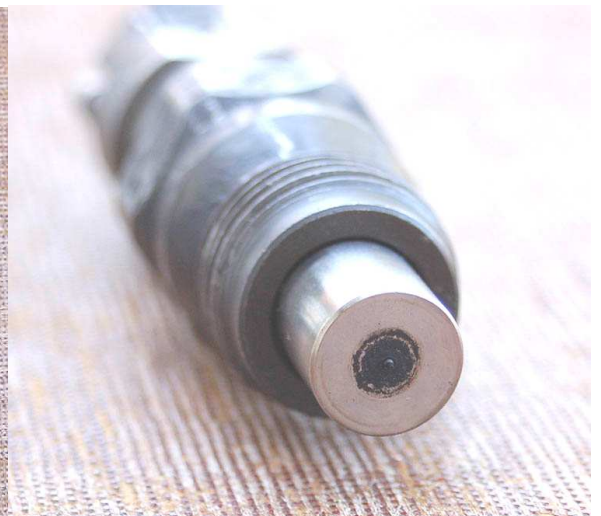
Zdjęcie 2 Widok na nową końcówkę wtryskiwacza (widoczna igła)
