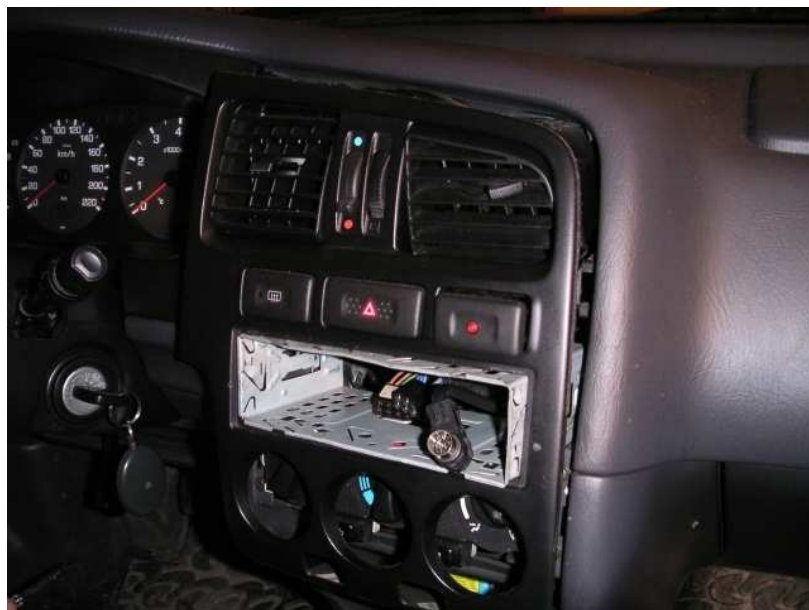
Zdjęcie 2. Demontaż konsoli środkowej.
