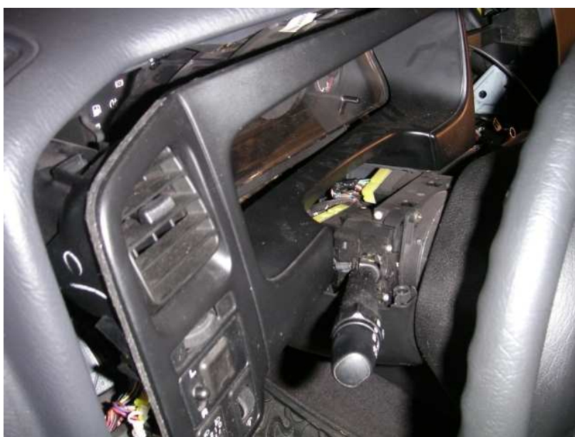
Zdjęcie 5. Demontaż osłony zegarów
